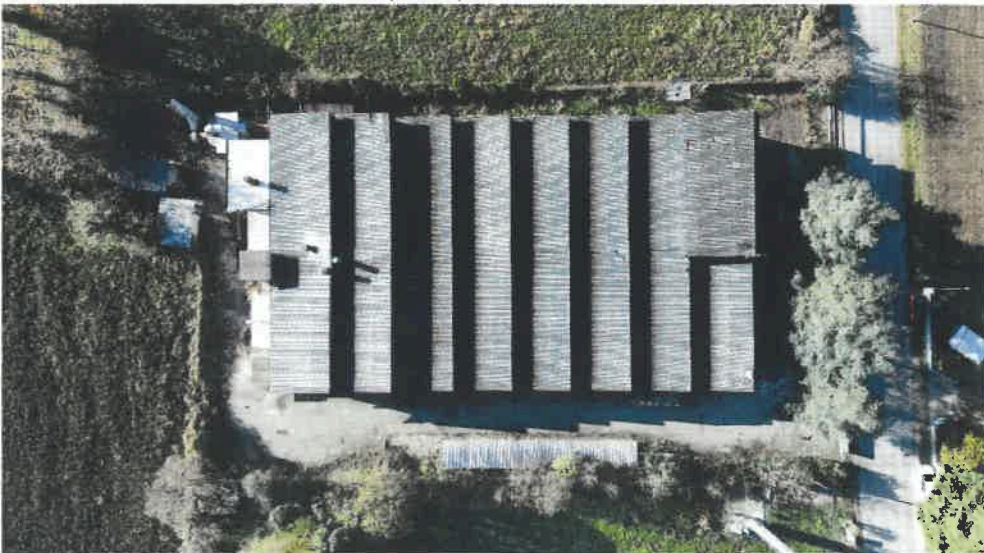
5. Foto: intero lotto e copertura (drone) – visibile la presenza di AMIANTO
